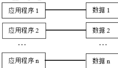
图5-1 人工管理阶段应用程序与数据的关系
